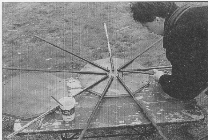
Nabenscheiben gebohrt, Speichen montieren. Schutzanstrich Firnis.
