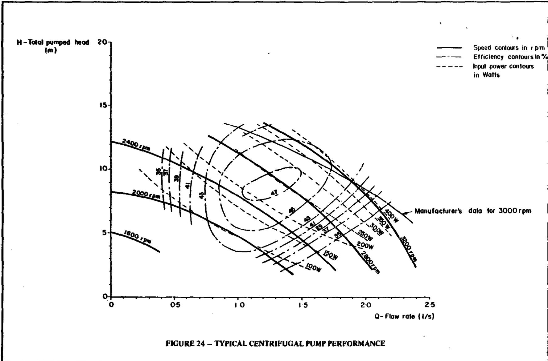
FIGURE 24 - TYPICAL CENTRIFUGAL PUMP PERFORMANCE
