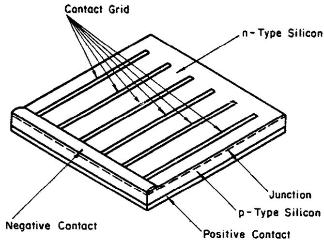
FIGURE 14 - SILICON SOLAR CELL
