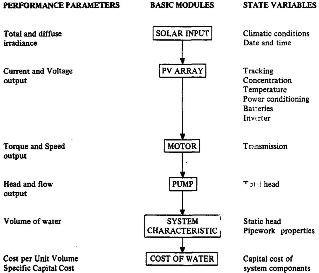
FIGURE 35 – BLOCK DIAGRAM FOR PHOTOVOLTAIC SYSTEM MODEL
