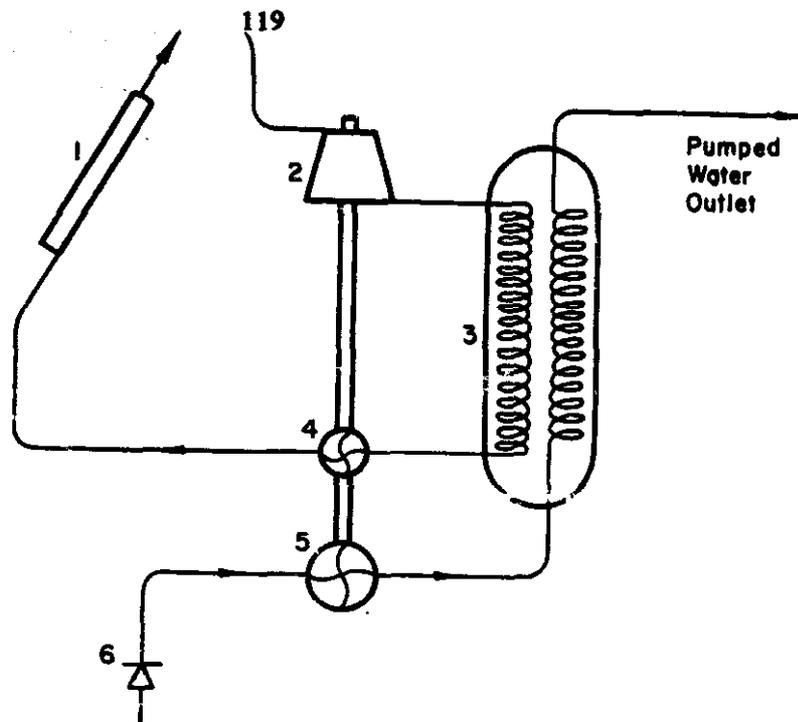
FIGURE 44 - SIMPLE RANKINE CYCLE
