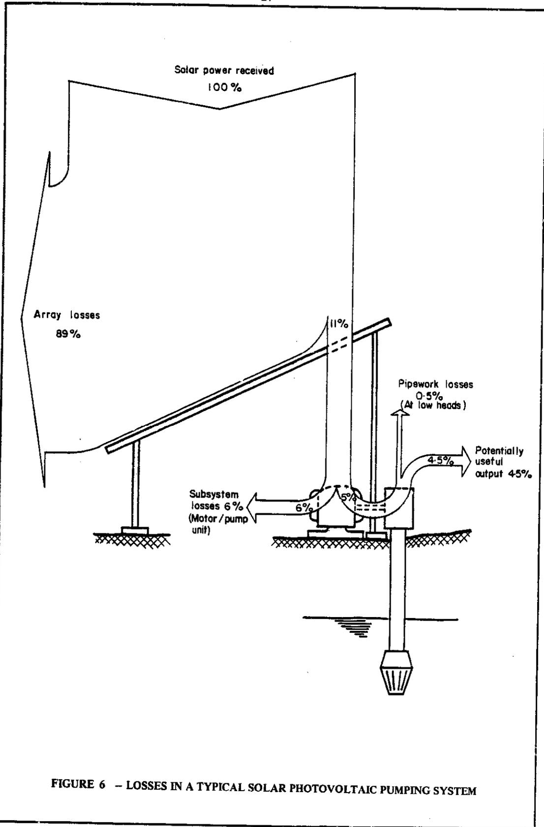
FIGURE 6 - LOSSES IN A TYPICAL SOLAR PHOTOVOLTAIC PUMPING SYSTEM
