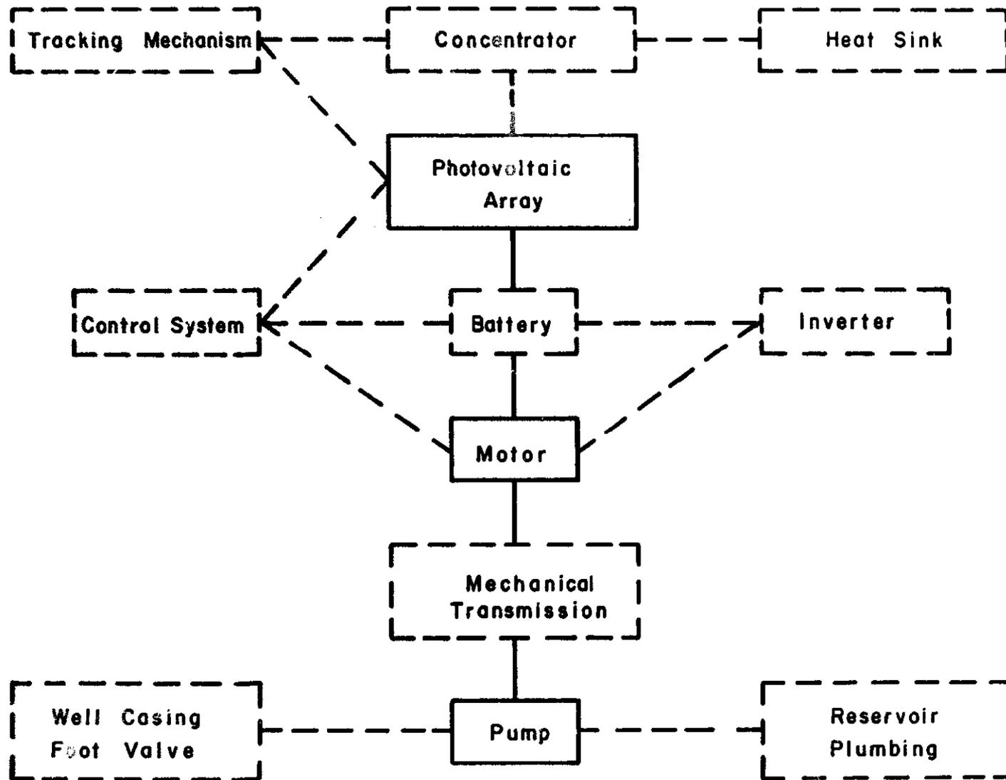
FIGURE 13 - SCHEMATIC ARRANGEMENT OF A PHOTOVOLTAIC SOLAR PUMPING SYSTEM
