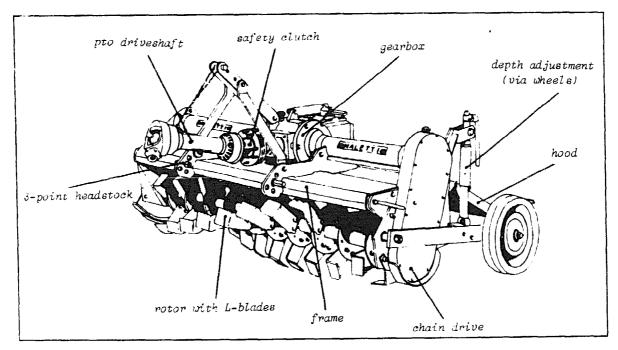
Fig. 47. Rotary tiller.
