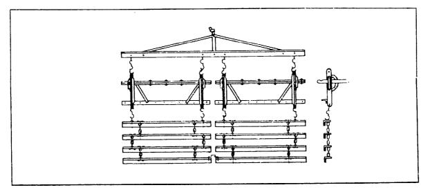
Fig. 89. Beam leveller (drag type).
